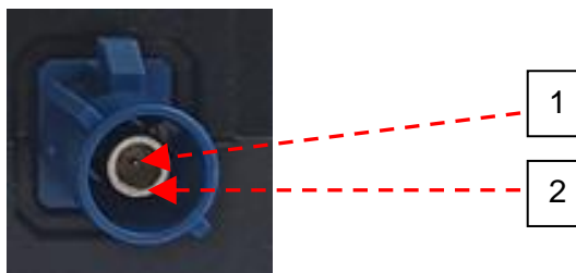
Рисунок 7 - Вид на контакты соединителя типа FAKRA-C
